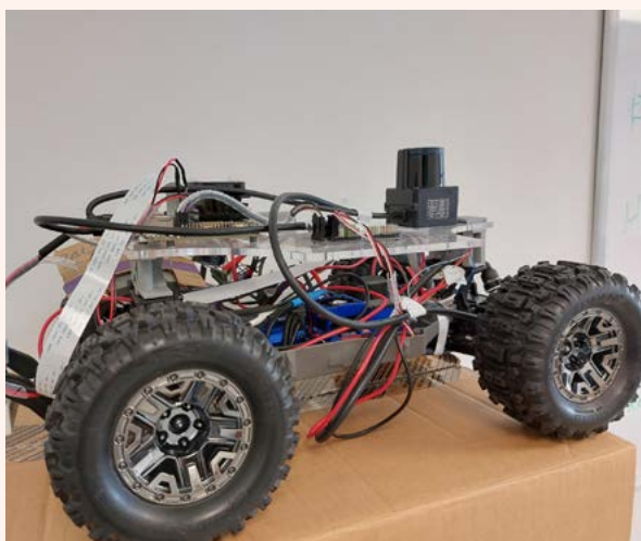
MAQUETTE D'UNE VOITURE AUTONOME F1/10 ème FONCTIONNANT AVEC UNE ARCHITECTURE LOGICIELLE EN TEMPS RÉEL, DÉVELOPPÉE PAR L'ÉQUIPE SYCOMORES
