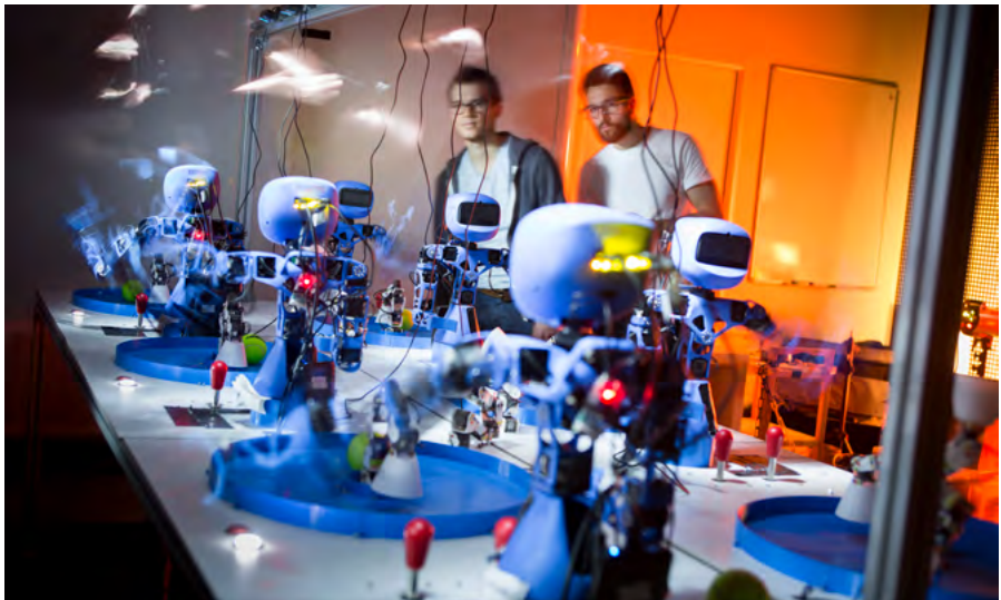
Chacun des six Poppy Torso doit apprendre de façon autonome en explorant ce qu'il y a autour de lui pour manier les manettes. © Inria / Photo C. Morel.
