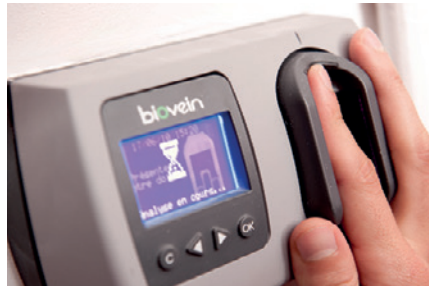
Contrôle d'accès opérant par reconnaissance d'iris ou des veines du doigt, permettant s'identifier afin d'accéder à la salle sécurisée du Laboratoire Haute Sécurité (LHS).
