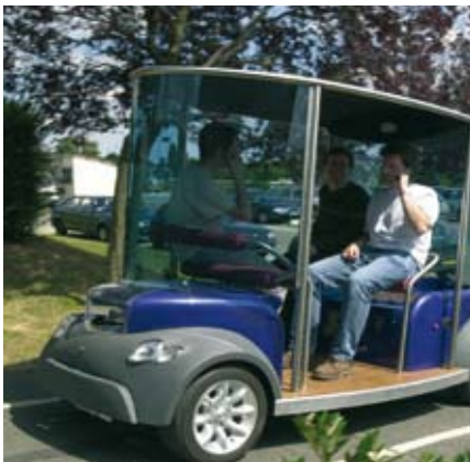
Cybercar, véhicule urbain à conduite entièrement automatisée, à l'INRIA Paris - Rocquencourt — IMARA.
