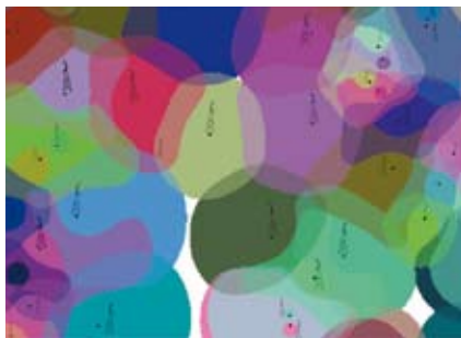
Modélisation de la couverture du réseau par des antennes utilisant le protocole CDMA (Code Division Multiple Access) — TREC.
