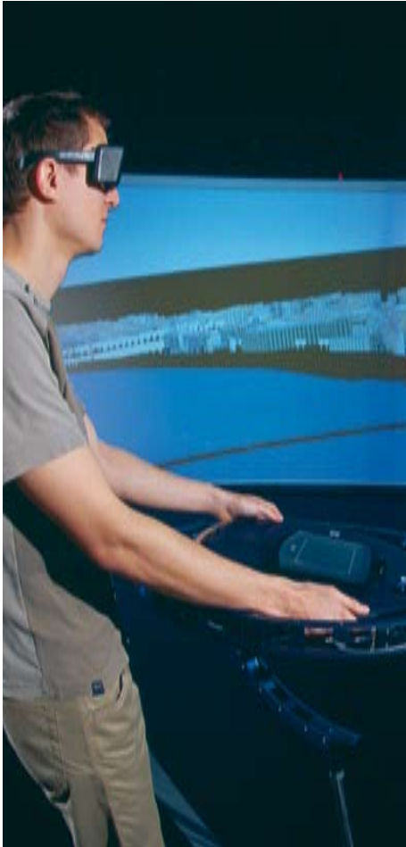
Le CAT (Contrôle Action Table), périphérique à 6 degrés de liberté pour environnement virtuel — IPARLA.
